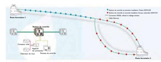
Première installation – finalisée en mai 2008: Une chaîne de 15 DDW-220 relie les stations de contrôle par une technologie SHDSL. Le câblage existant a été utilisé. Les stations de contrôle sont distantes de 2 à 4 km. Seconde installation – finalisée en décembre 2008: Une série de DDW-221 configurée en anneau redondant a été ajoutée au système pour accroître la robustesse du réseau.
